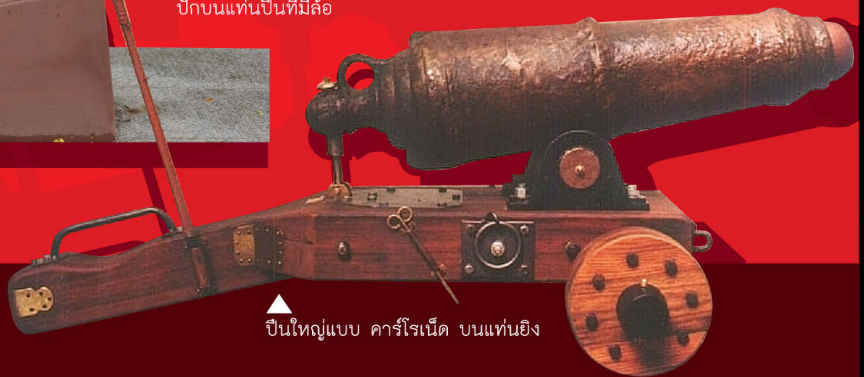
ปืนใหญ่แบบ คาร์โรเนด รุ่นแรกๆ มีเพลายึดด้านล่าง ของลำกล้องและที่ด้านท้าย ปืนมีห่วงสำหรับคล้องหลัก ปักบนแท่นปืนที่มีล้อ
