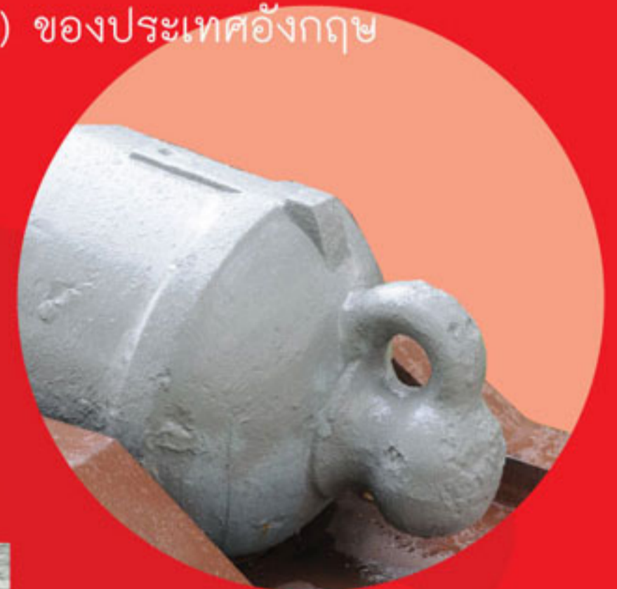
▲ ท่วงเหล็กไว้คล้องเชือกรับแรงสะท้อนที่เกิดจากการยิง
