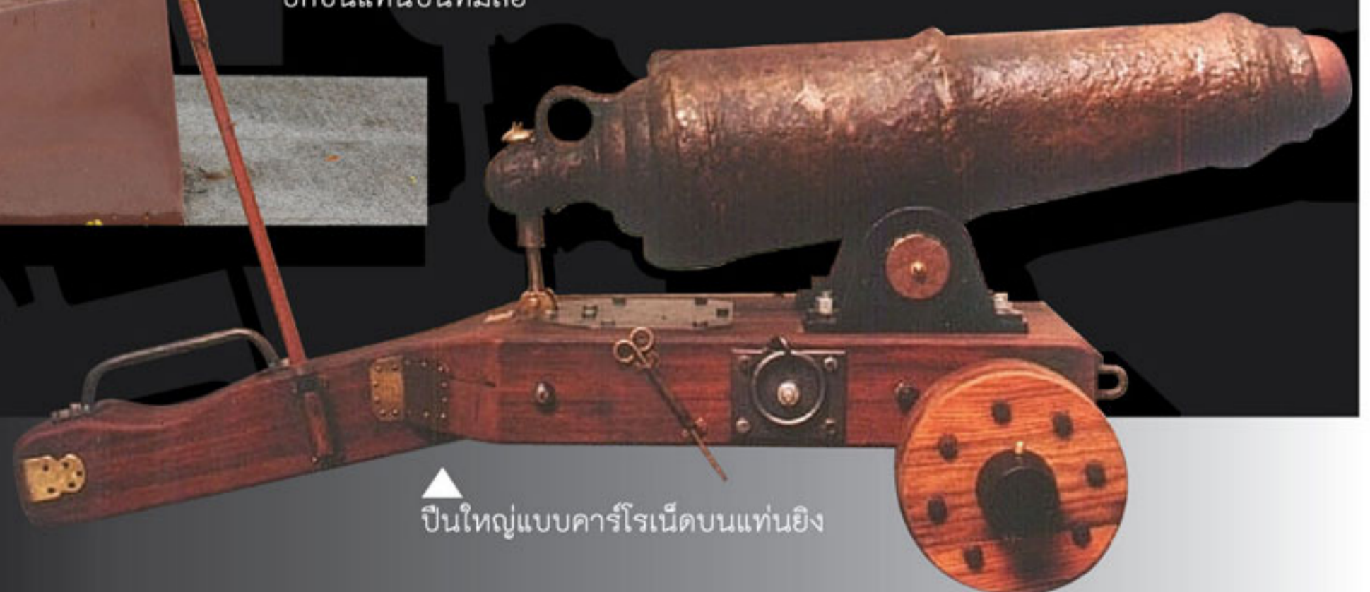
ปืนใหญ่แบบคาร์โรเน็ตรุ่นแรกๆ มีเพลาด้านล่างของลำกล้องและที่ด้านท้ายปืนมีห่วงสำหรับคล้องหลักปักบนแท่นปืนที่มีล้อ
